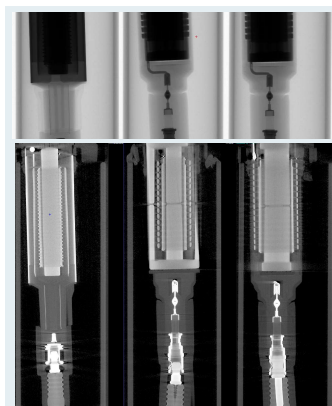
Abbildung 2: PolyCT Scan von drei Einspritzdüsen. Oben: Ausschnitt der Radioskopie der Messung. Unten: Schnittbild der Rekonstruierten 3D Volumen
