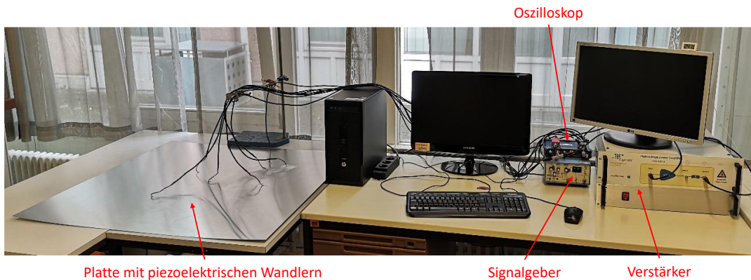
Abb. 5. Versuchsaufbau zur Validierung der geführten Wellen
