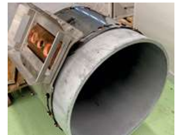
Bild 1: Konzeptdarstellung der integrierten Spulen und Sensoren in beliebiger Länge
