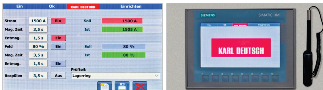
Abb. 10. Einstellung und Abspeicherung der Prüfparameter über die MEMORY-Software und Bedienung über Touchpanel
