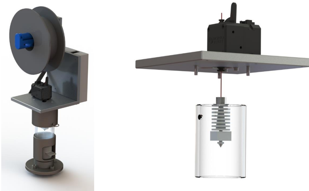
Abb. 2: Für Röntgenaufnahmen optimierter FFF-Drucker; Links: Gesamtansicht; Rechts: Vergrößerung mit ausgeblendeten Bereichen
